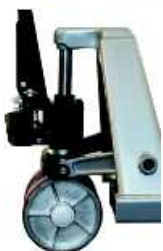
Lukket hydrauliksystem med helstøbt hus
