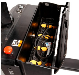
210 Ah truckbatteri. 280 Ah på T20-25RA
