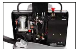
Indbygget lader og vedligeholdelsesfrie batterier
