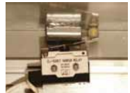
Den øvre platform har en sikkerhedsramme siderne rundt. Rammen er forsynet med en dobbelt afbryderfunktion til kontrolleret og sikker sænkning af platformen
